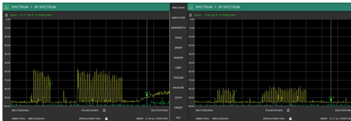
Figura 9: Comparação da intensidade do sinal coletado no espectro de operação da comunicação, sendo o ponto 17 à esquerda e o ponto 20 à direita.
