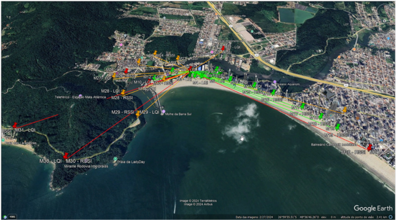
Figura 8: Mapeamento da intensidade e qualidade do sinal entre o AP e um medidor de teste.
